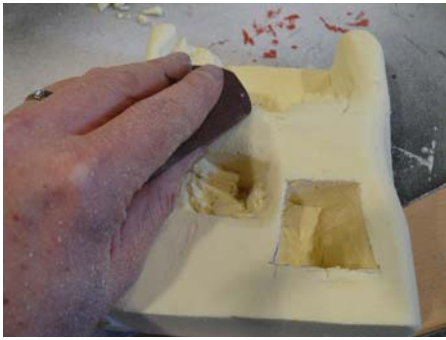
Gute Ergebnisse erzielt man mit 100er Schleifpapier
